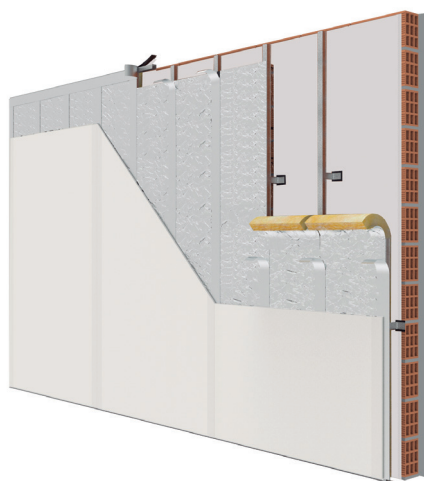
Retrofit interior con Lana de vidrio y placa de roca de yeso
